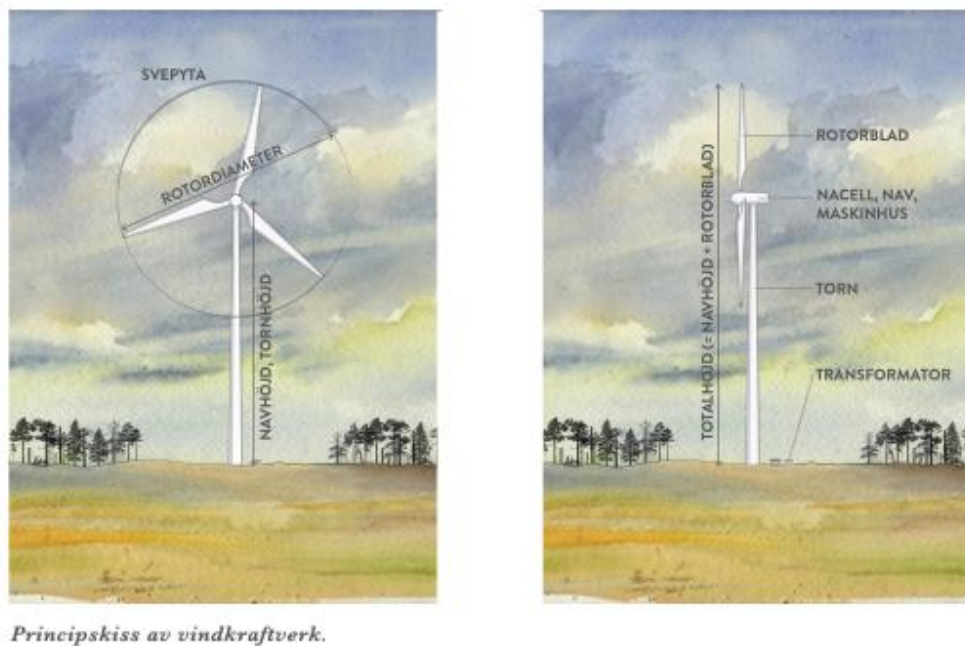
Figur 3 Principskiss av vindkraftverkets delar.
